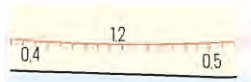
Берег затопляемый с пойменной бровкой (1,2 - высота затопляемой бровки; 0,4 и 0,5 - высоты затопляемого берега)
